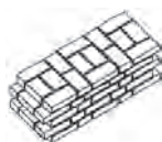
Fig. 3.1 – Pc: sezione a paramenti ben collegati o ad unico paramento (sezione piena)
